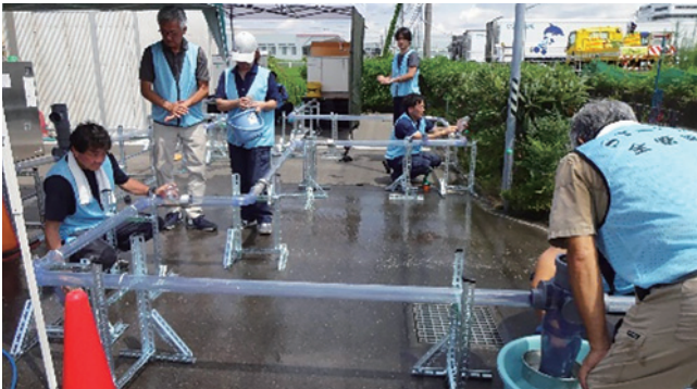
写真1 供試排水配管
